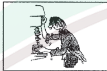
مسك القطعة باليد أثناء عملية الثقب
