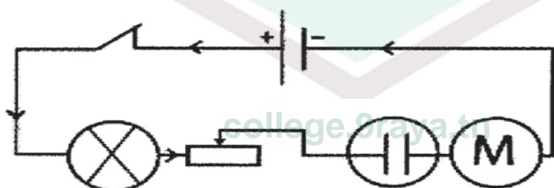
3) L'interrupteur : commander le fonctionnement du circuit.
