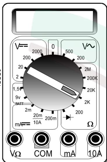
3 ) حدد أقطاب الملتيمتر المستعملة لقياس التوتر الكهربائي .
